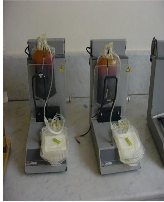
Figure 8: des poches placées dans les presses
